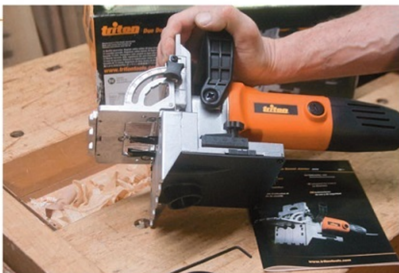
Sul lato sinistro della macchina la regolazione della profondità di foratura, e quella dell'angolazione della guida. Nella foto le punte nella loro escursione massima.
