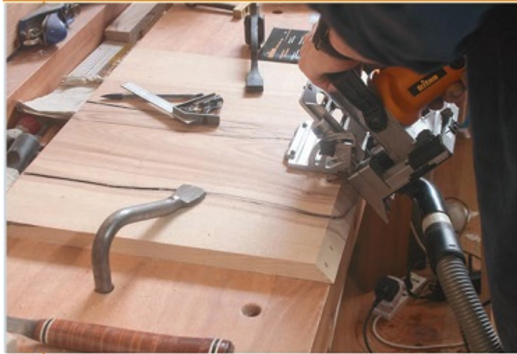
La macchina in uso su una giunzione angolata e punte da 6 mm.
